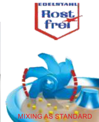
Bi-directional, slow knife mixing speeds. Mischgang vorwärts/rückwärts. Mélange vitesse lente couteaux dans les deux sens. Mélange vitesse lente couteaux dans les deux sens. Mengen lage snelheid messen in zwei richtingen. Langsom blandegang forlæns/baglæns. Impasto velocità lenta lame in due sensi. Amasado velocidad lenta en los dos sentidos.
